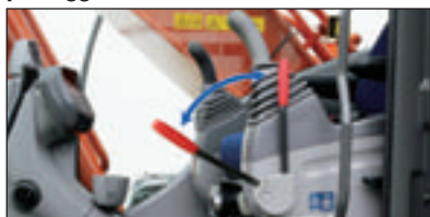
Leva di neutralizzazione circuito di pilotaggio
