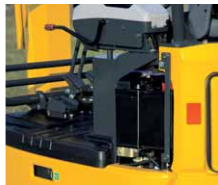
Cofano sinistro: accesso alla batteria
