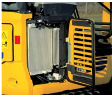
Cofano destro: ispezione e pulizia dei radiatori
